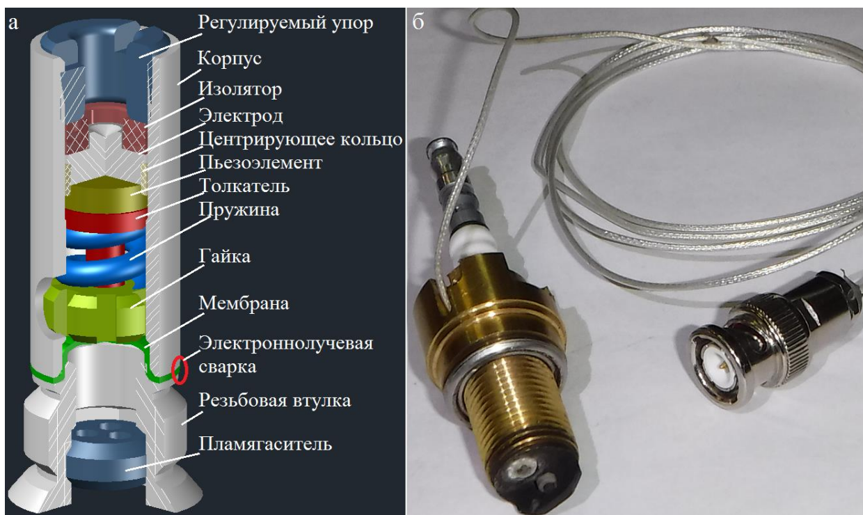
Рис. 1. а – конструкция миниатюрного датчика давления, б – датчик давления совмещенный со свечей зажигания (датчик-свеча)
