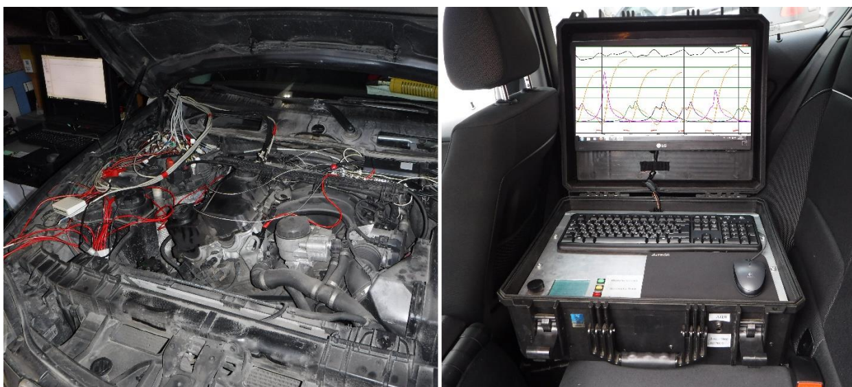
Рис. 2. Автомобиль с подключенным ДК ДВС
