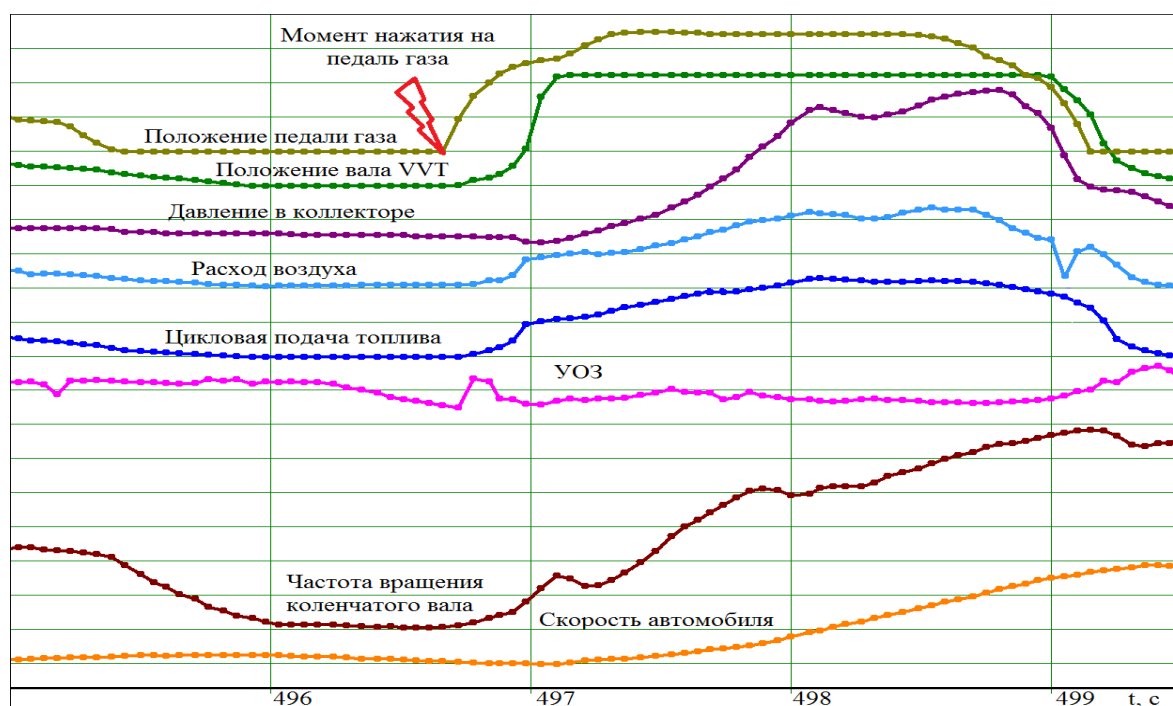
Рис. 5. Пример фрагмента данных от контроллера ЭСУД в функции времени
