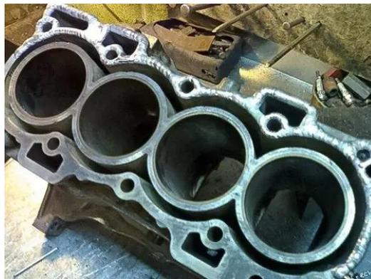
*Рис. 9. Пример заварки трещин на привалочной плоскости блока цилиндров*
