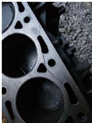
*Рис. 4. Трещины на привалочной плоскости блока цилиндров под головку блока цилиндров между водяными полостями системы охлаждения*
