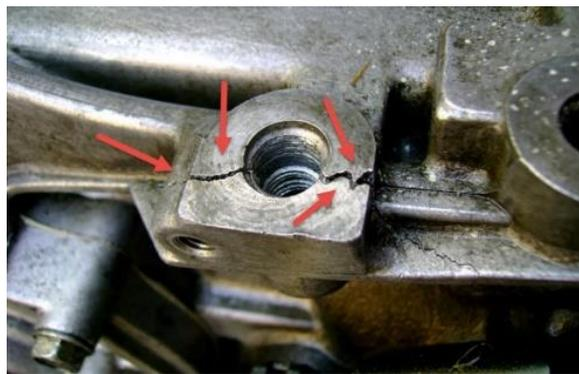
*Рис. 3. Трещины на бобышках с резьбовыми отверстиями*
