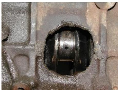
*Рис. 5. Пробоина в картерной части блока цилиндров – «рука дружбы»*
