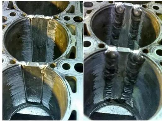
*Рис. 8. Пример заваривания трещин по перемычкам между цилиндрыми отверстиями*
