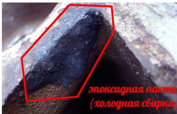
Рис. 11. Заделка трещины на внешней стороне рубашки охлаждения блока цилиндров эпоксидной пастой (холодная сварка)
