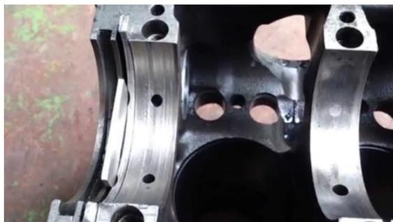
*Рис. 6. Трещины на коренных постелях с проворотом вкладыша*
