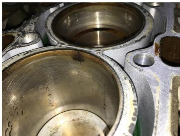
*Рис. 1. Трещины по перемычкам между цилиндрами*
