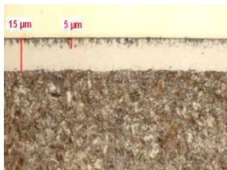
Рис.5. Структура конструкционной стали после карбонитрирования
