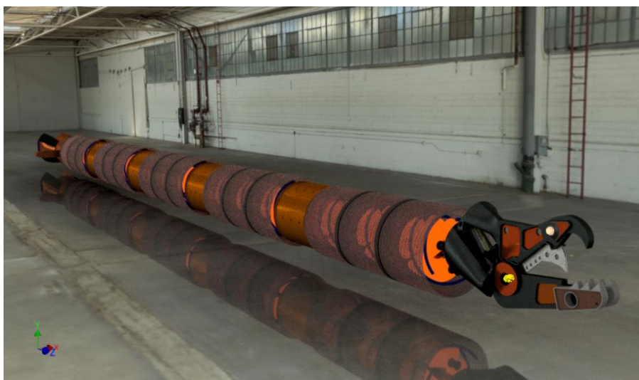
Рис. 2. Гибкая стрела с гидроножицами
