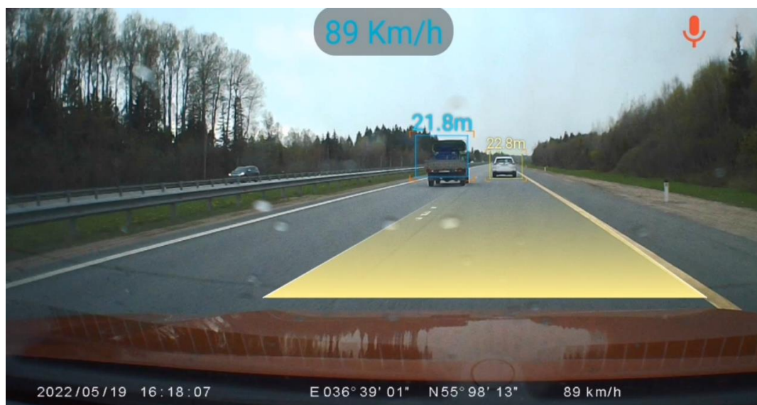
Рис. 1. Видеорегистратор, оснащенный системой ADAS на базе android
