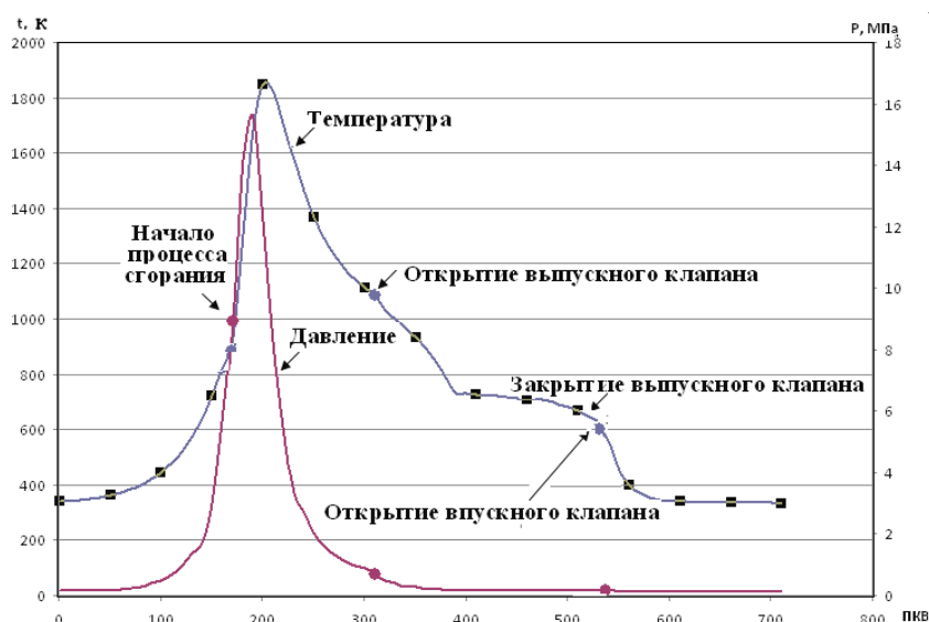
Рис. 8. Показатели рабочего процесса, рассчитанные для дизеля ( S/D = 124/107 , \varepsilon = 17,3 ): цикловая подача топлива 100 \text{ мг} , n=1625 \text{ мин}^{-1} , p_e = 1,66 \text{ МПа}
