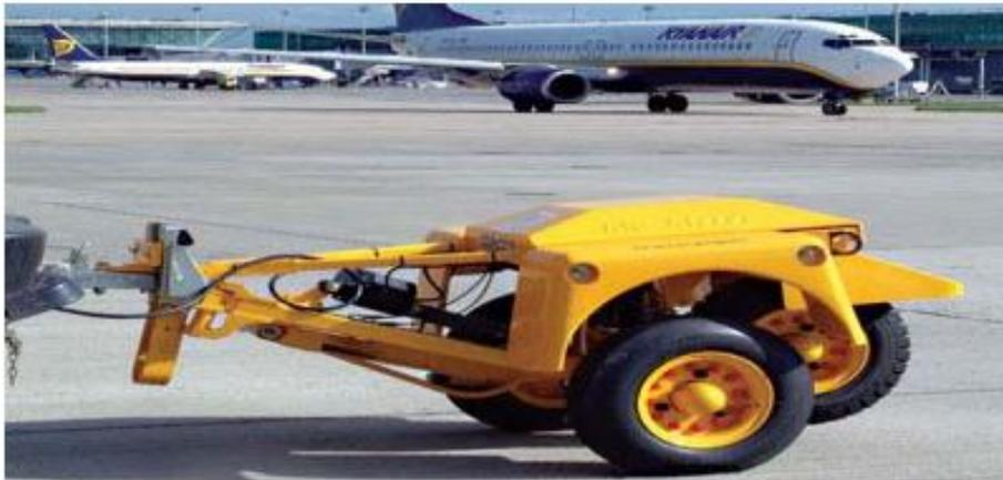
*Рис. 2. Прибор для измерения поперечного сцепления колеса с покрытием мю-метр, США*
