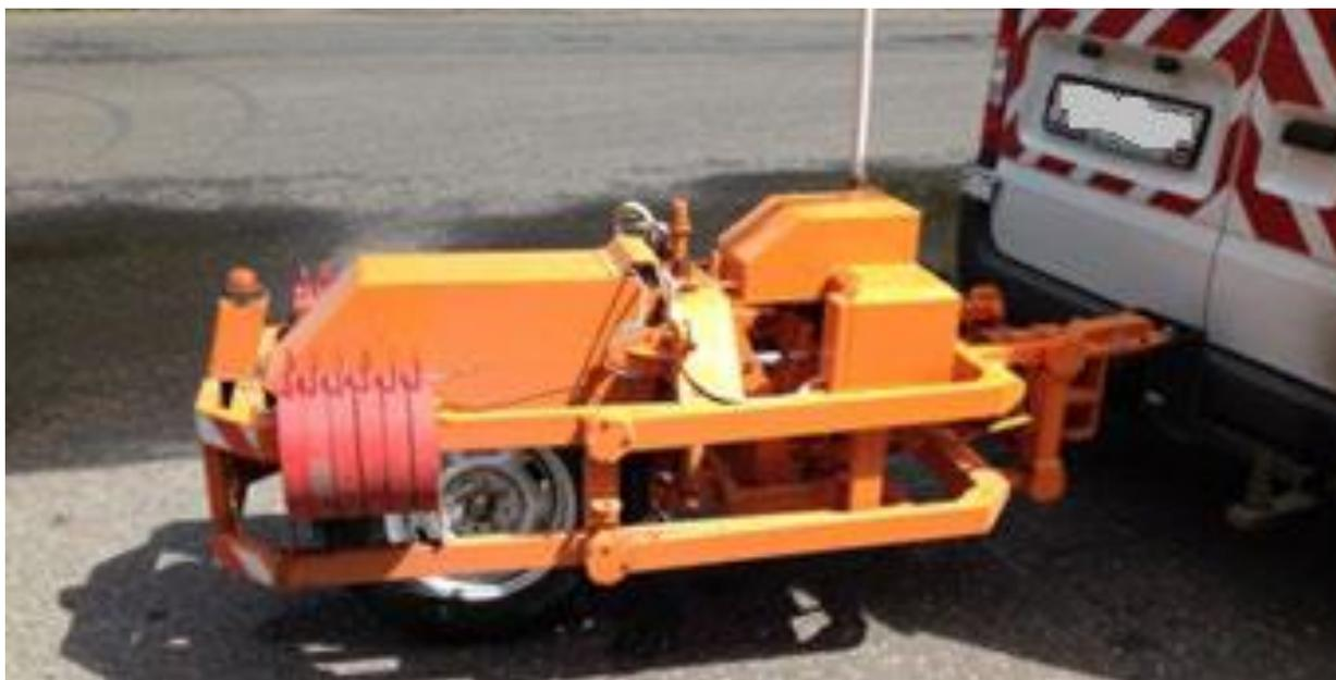
*Рис. 3. Внешний вид измерительного прибора ПКРС-2У [4]*
