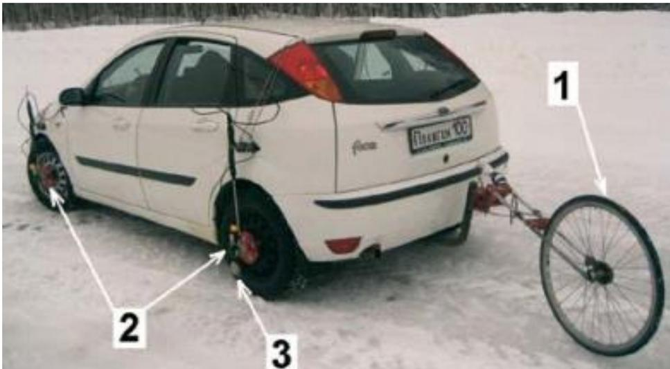
*Рис. 4. Транспортное средство – колесный (шинный) тестер;
