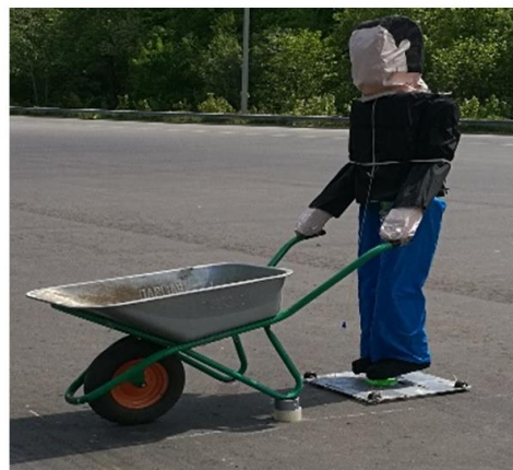
Рис. 4. 3D модель пешехода с ручной тележкой в системе ПАК и реальная тачка с макетом пешехода при полигонных испытаниях
