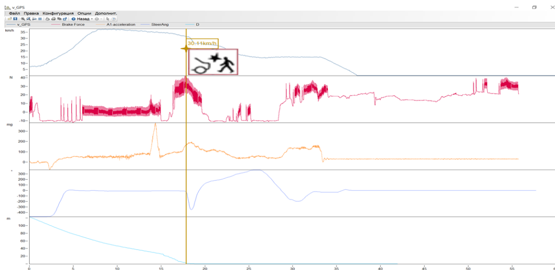
Рис. 5. График результатов заезда автомобиля Toyota RAV4 с сообщением о виртуальном наезде на пешехода с тачкой
