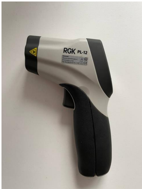
Рис. 5. Пирометр RGK PL-12
