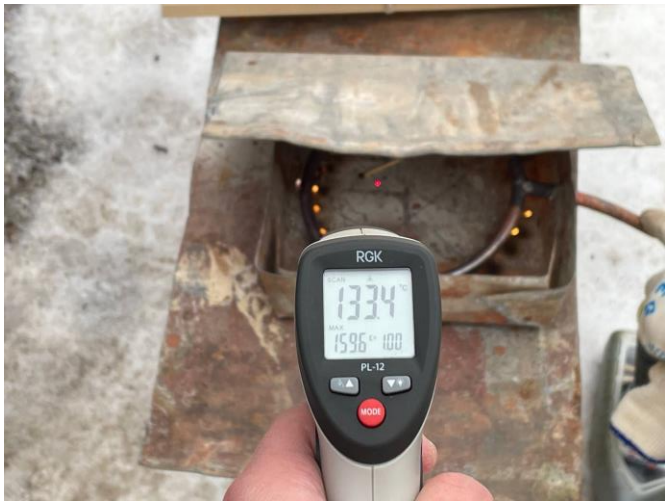
Рис. 8. Показания пирометра спустя 10 минут нагрева плиты
