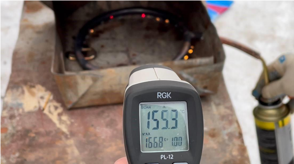
Рис. 9. Показания пирометра спустя 15 минут нагрева плиты
