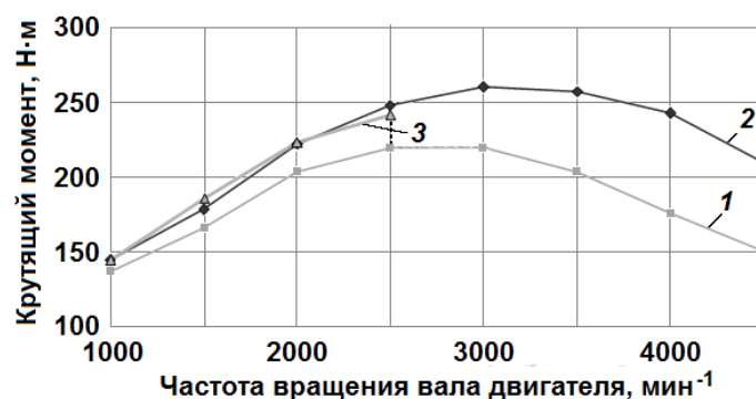
Рис. 6. Крутящий момент двигателя на режимах ВСХ: 1 – в четырехтактном цикле; 2 – в двухтактном цикле; 3 – с возможностью переключения на четырехтактный цикл
