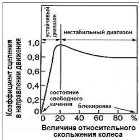
Рис. 1. Зависимость коэффициента сцепления от величины относительного скольжения колеса. Источник: [7]
