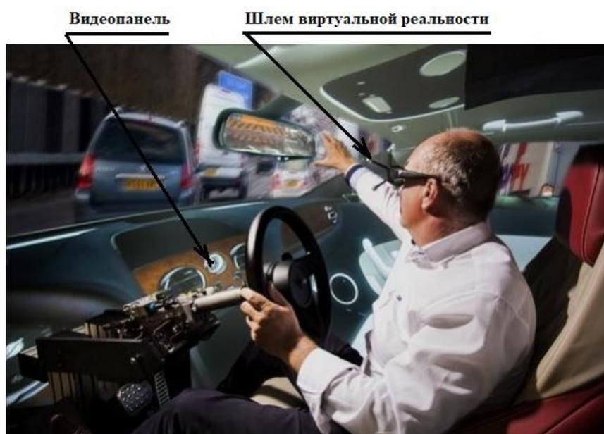
*Рис. 2. Использование смешанной реальности при отработке эргономики Бентли*
