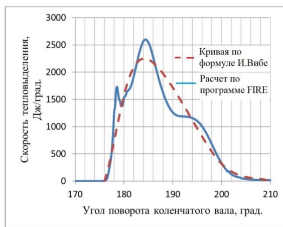
Рис. 6. Скорость тепловыделения газодизеля: \varphi_z = 36 град., m = 1,0
