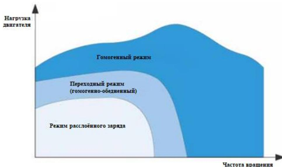
Рис. 1. Распределение коэффициента избытка воздуха в двигателях с непосредственным впрыскиванием бензина
