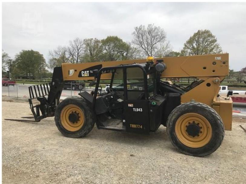
Рис. 2. Телескопический погрузчик TL943D
