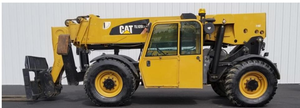
*Рис. 3. Телескопический погрузчик TL1255D*
