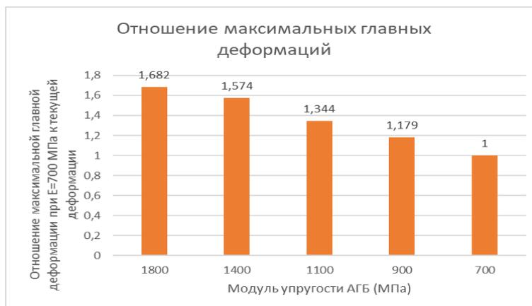
Рис. 9. Гистограмма оценки влияния различных типов АГБ на процесс образования колеи в регенерированном АБ покрытии
