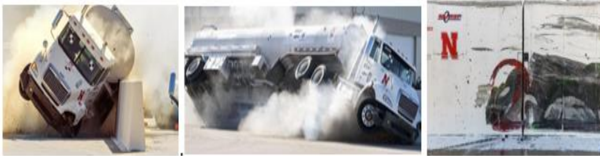
Рис. 6. Краш-тест парашокного ограждения методом наезда трейлера массой 36 т. со скоростью 80 км/ч
