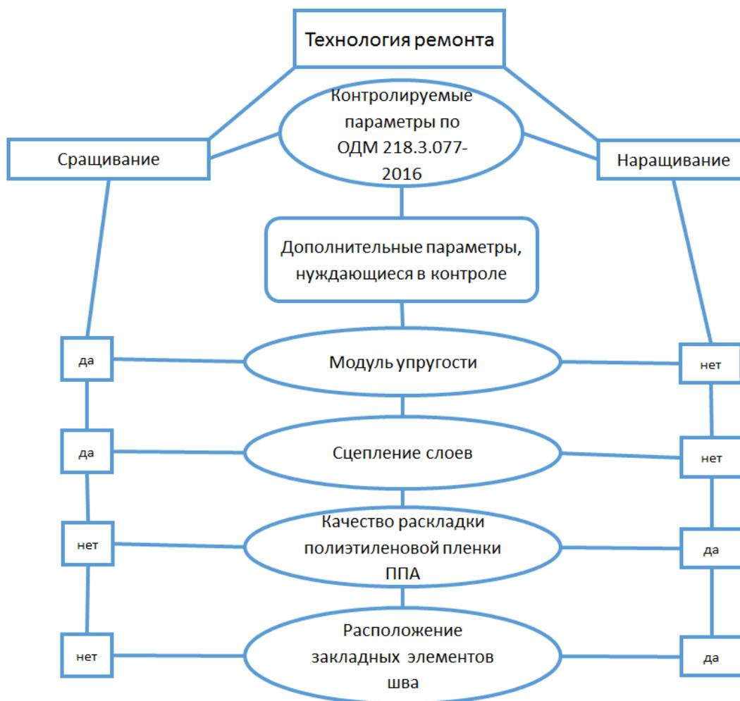
*Рис. 3. Схема контроля качества дополнительных параметров при ремонте асфальтобетонных поверхностей цементбетоном*
