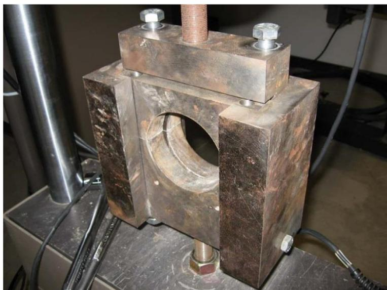
*Рис.5. Установка для испытания сцепления слоев асфальтобетона и цементбетона*
