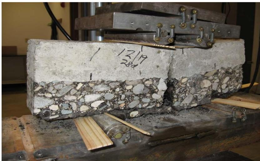
*Рис. 4. Испытания на изгиб объединенного образца*
