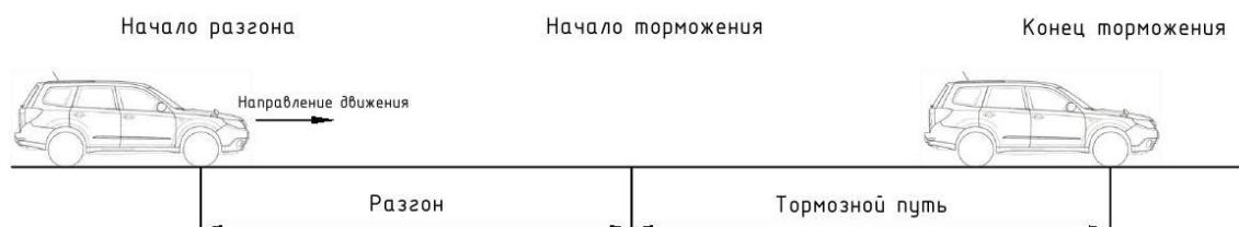
Рис. 4. Схема методики проведения испытания.
