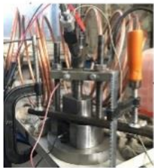
Рис. 1. Схема исследовательской установки для испытаний аккумуляторной топливной системы дизеля
