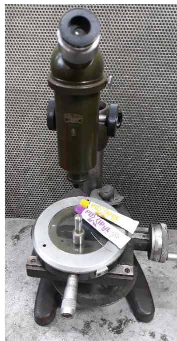
Рис. 2. Подготовка распылителя ЭГФ к испытаниям
