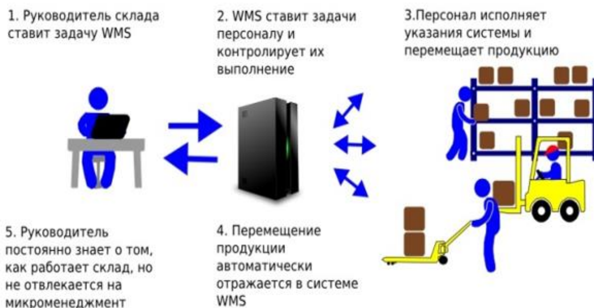
Рис. 2. Принцип работы WMS-систем
