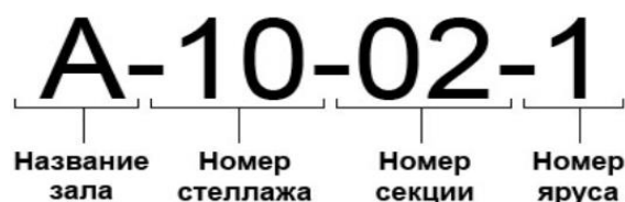
Рис. 5. Структура номера штрих-кода для ячейки на складе
