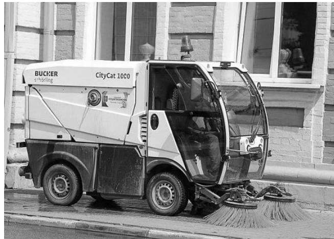
Рис. 1. Подметание пешеходной зоны CityCat 1000
