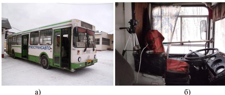
Рис. 1. Внешний вид автобуса, на котором производились испытания (а) и расположение записывающей аппаратуры в кабине (б)
