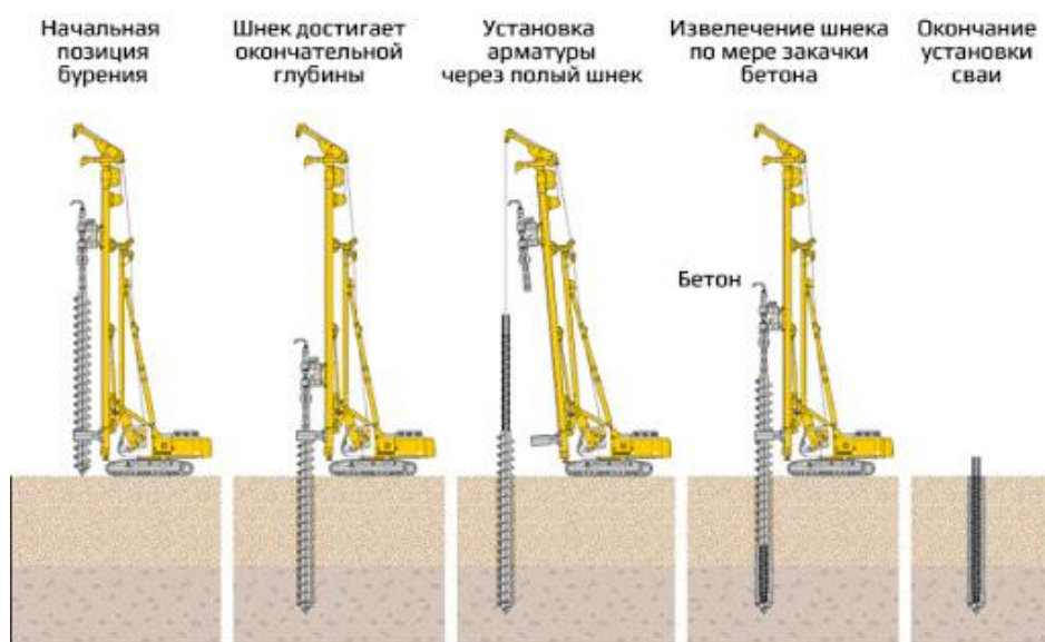
Рис. 2. Бурение скважин под свайный фундамент
